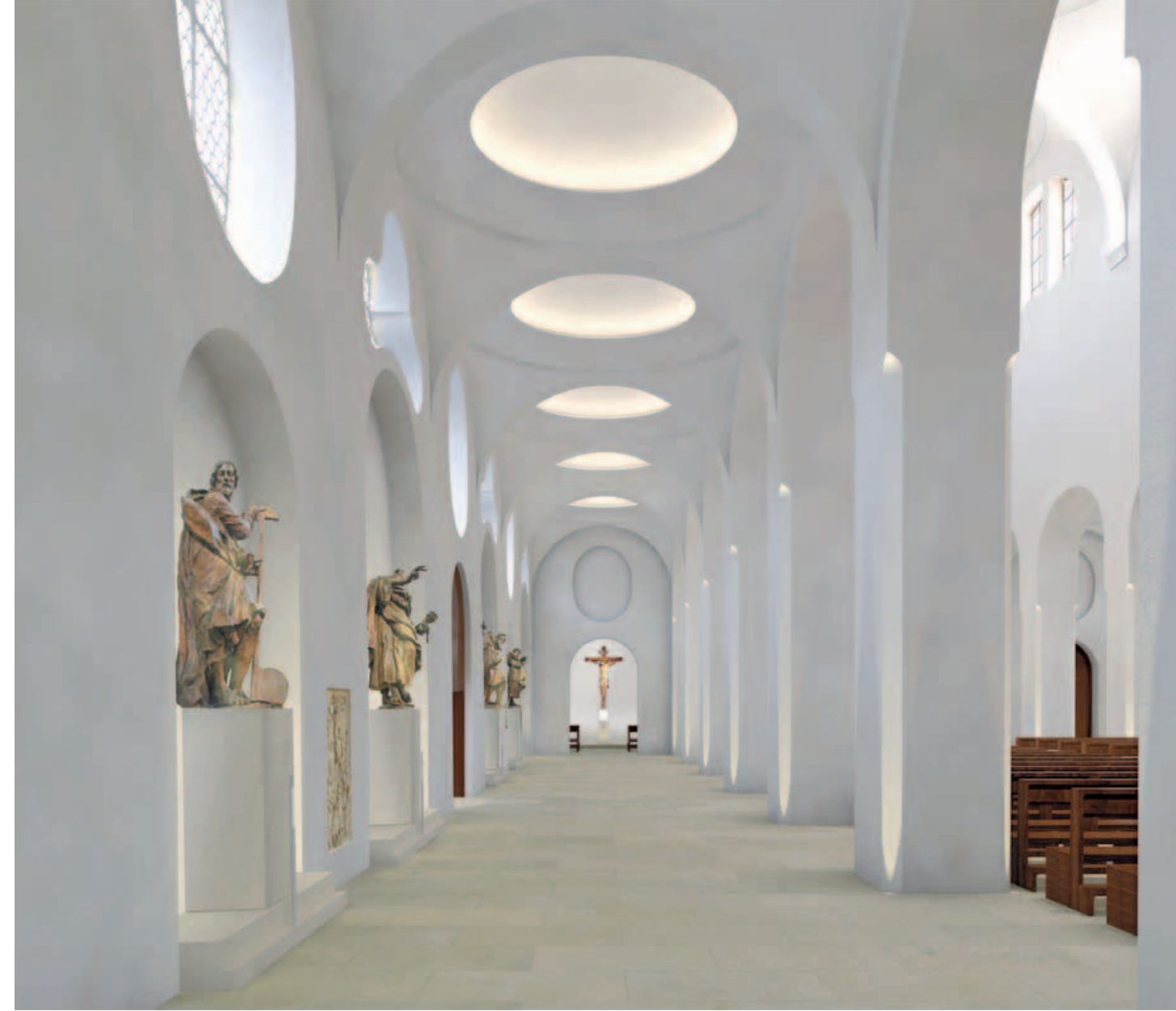
Entstehung des Lichtkonzeptes am Beispiel des nördlichen Seitenschiffs der Moritzkirche: allen Planungen geht eine genaue Analyse der Beleuchtungssituation zu den unterschiedlichen Tages- und Jahreszeiten voraus. Mit exakt ausgewählten Beleuchtungsquellen, die in Intensität und Wärme variieren, wird der Blick in die Tiefe des Raumes gezogen, wie hier in die künftige Sakramentskapelle. Einzelne architektonische Strukturen werden durch Lichtkanten nachgezeichnet. Die seitlichen Nischen erhalten durch die Apostelfiguren wieder eine besondere Funktion zurück und werden mit Licht ebenso markiert.
